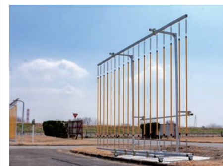
可動式立体障害物を導入することで、中型1種・2種の両設置基準に対応可能となります。
